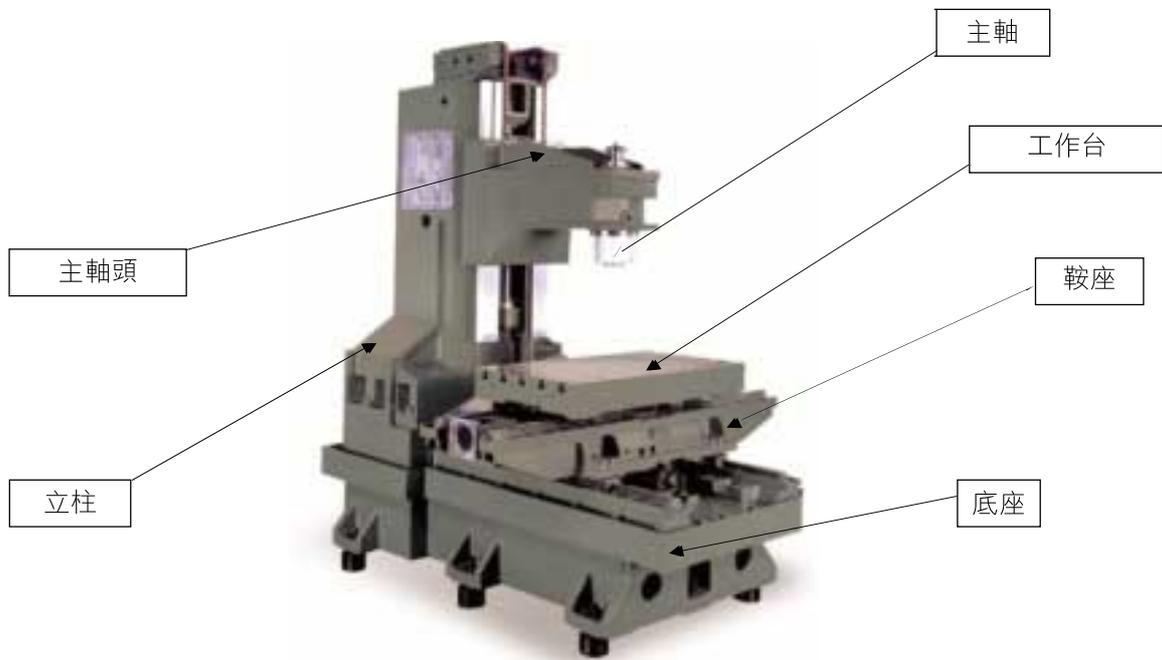
以其加工中心機的技術及科技作為基礎，本集團亦為對加工及生產要求較高的製造商設計及生產整合生產線。整合生產線的運作模式是，進行不同加工工序的多台立式加工中心機以直線排列。工件的加工工序從生產線的第一台立式加工中心機開始。部份完成工件將經由輸送帶自動或經手動（視乎客戶要求而定）送往生產線的下一台立式加工中心機，以繼續進行加工。
